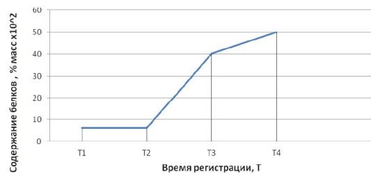
Рис.6. Регистрация протечки безалкогольного напитка в хладоноситель по содержанию углеводов
